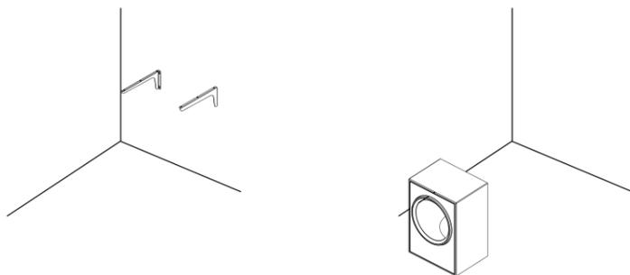
Разметить место для установки кронштейнов (схема 1) так, чтобы в результате, раковина и стиральная машина расположилась согласно схемы 2.
