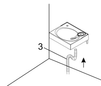
После установки раковины на кронштейны, присоединить сифон гофрированный (поз.3).
